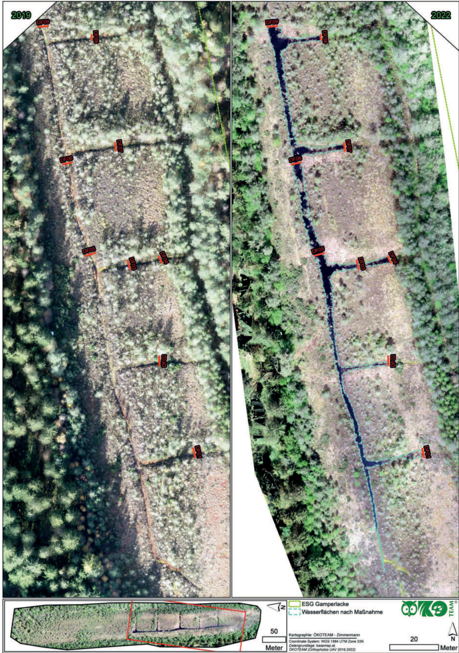
Abb. 3: Orthophotos des renaturierten Moorbereichs 2019 (links) und 2022 (rechts). Durch die Maßnahmen (rot: Spundwände) entstanden rund 1.200 m 2 neue Moorgewässer. (Fotos und Aufbereitung: Philipp ZIMMERMANN).
