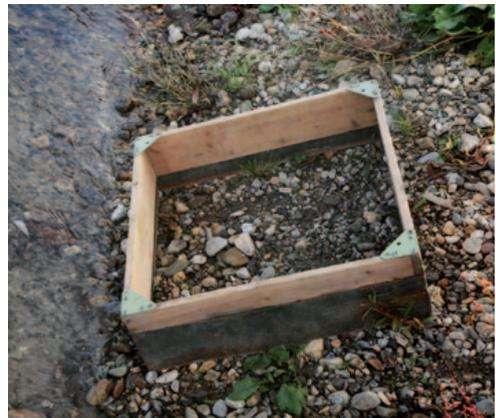
**Abb. 28:** Rahmen für den quantitativen Quadrattfang (0,25 m<sup>2</sup>) an vegetationslosen Alluvionen.
